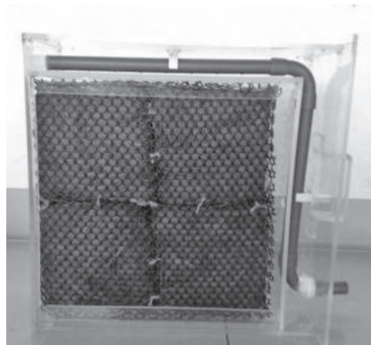
รูปที่ 5 ภาพการติดตั้งแผ่นทำความเย็น
